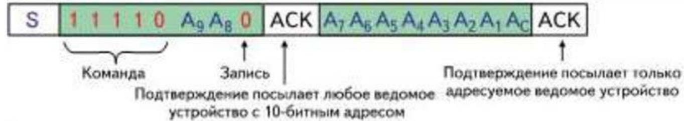
Рисунок 28 – 10-и битный формат протокола I<sup>2</sup>C
