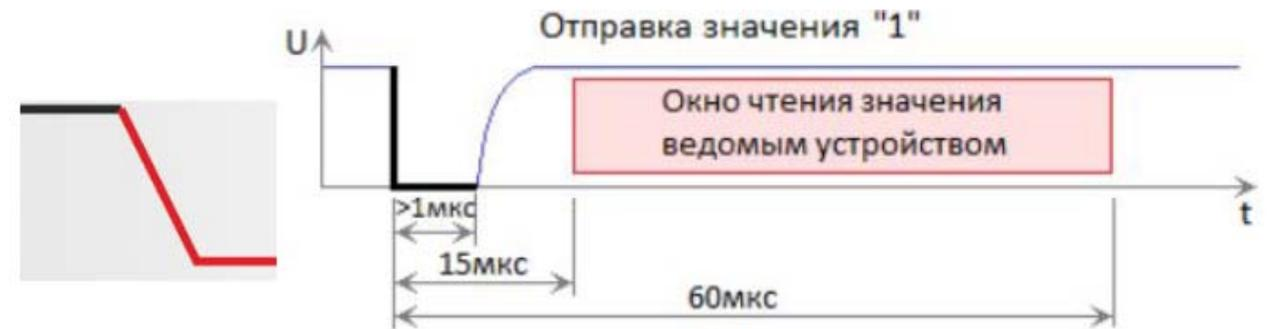
**Сигнал "Запись 1"**. Ведущий устанавливает низкий уровень в течение 1...15 мкс. После этого, в течение оставшейся части временного слота он освобождает шину.
