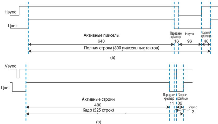
Рис. 9.22 Временные диаграммы синхроимпульсов VGA: (а) по горизонтали, (б) по вертикали
