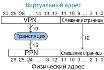
Рис. 8.22 Трансляция виртуального адреса в физический
