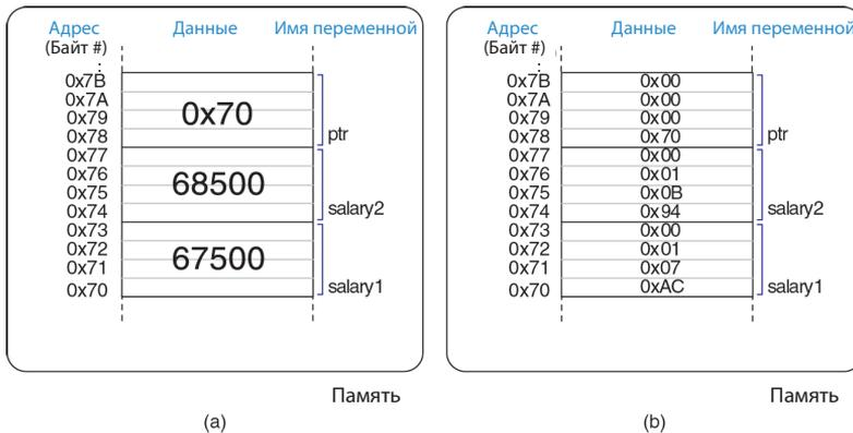
**Рис. С.3** Содержимое памяти после выполнения кода из примера С.18: а) значения переменных, б) содержимое ячеек памяти при использовании порядка байтов от младшего к старшему
