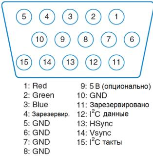
**Рис. 9.23** Схема расположения выводов разъема VGA
