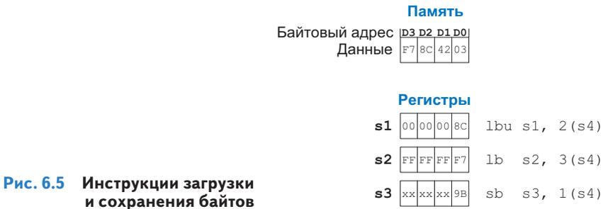
**Рис. 6.5** Инструкции загрузки и сохранения байтов
