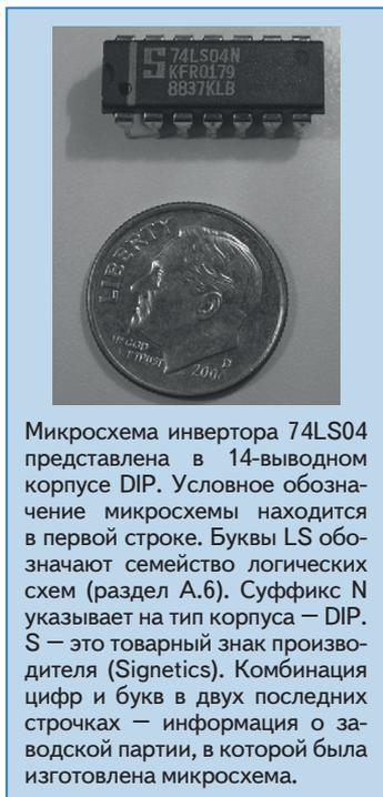
Микросхема инвертора 74LS04 представлена в 14-выводном корпусе DIP. Условное обозначение микросхемы находится в первой строке. Буквы LS обозначают семейство логических схем (раздел А.6). Суффикс N указывает на тип корпуса – DIP. S – это товарный знак производителя (Signetics). Комбинация цифр и букв в двух последних строчках – информация о заводской партии, в которой была изготовлена микросхема.
