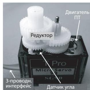
**Рис. 9.33 Серводвигатель SG90**
