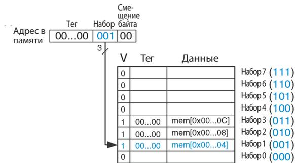
**Рис. 8.8** Содержимое кеша прямого отображения
