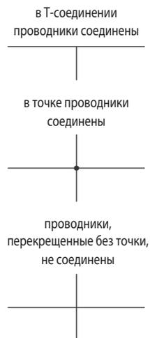
Рис. 2.24 Способы соединения проводников
