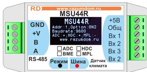
При включении питания дисплей будет показывать в течении 7 секунд общую информацию. Название MSU44R, адрес Modbus, четность 8N2, скорость 9600, подключенные сенсоры, производитель www.razumdom.ru. Затем переключится на страницу. Номер страницы сохраняется при отключении питания.
