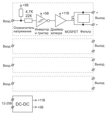
Модуль может выступать в качестве твердотельного реле постоянного тока. Модуль работает только с постоянным током. Подключать переменный ток нельзя. Необходимо соблюдать полярность. В другом направлении установлены обратные диоды.
