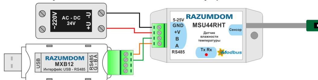
Подключать шину RS-485 необходимо последовательно каждый вывод А и В, и на двух концах кабеля должны быть подключены терминальные резисторы по 120 Ом между А и В. А питание нужно подключать от источника питания к модулям с общей точкой в источнике питания.
